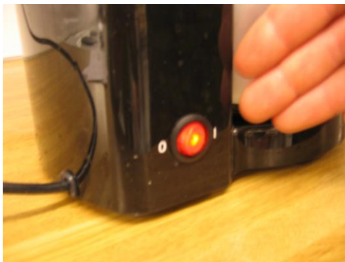
Fig 13. Strömbrytare i läge drift (kontrollampa lyser)
